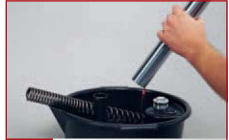
3. Obere Gabelverschluss-schraube entfernen und Gabelöl ausgießen
